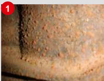
Corrosão no bloco do motor causada por água com tratamento inadequado
